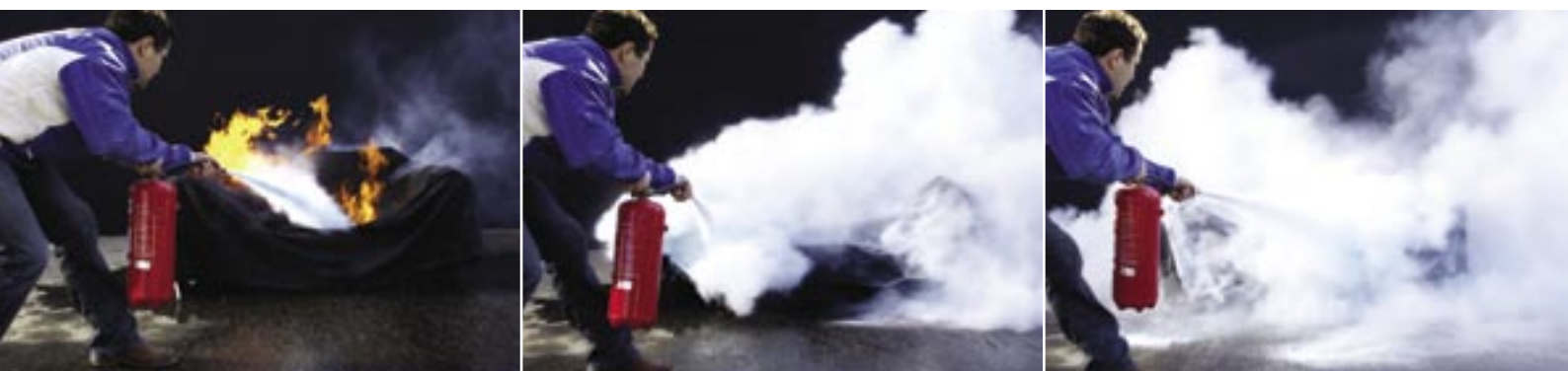
Tradisjonelle pulverslokker har også høy slokkeeffekt, men påfører store sekundærskader.
